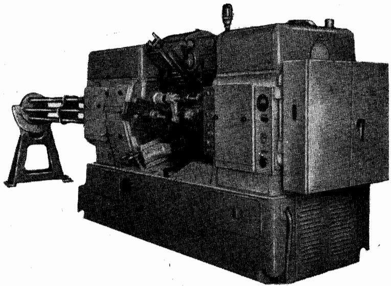
Автомат предназначен для обработки сложных и точных деталей из калиброванных прутковых заготовок круглого, шестиугольного, квадратного сечения различных марок сталей и цветных металлов в условиях массового, крупносерийного производства.
