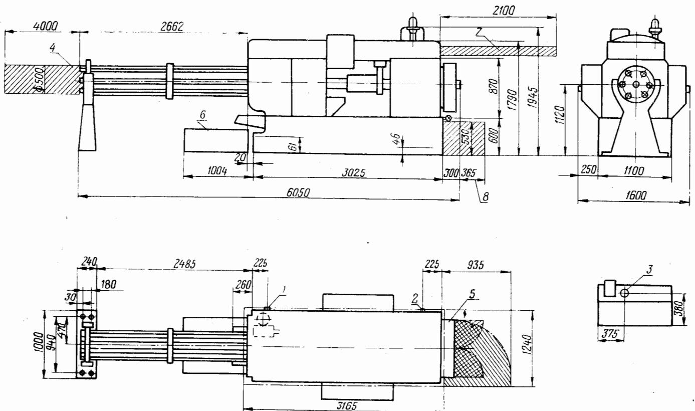
1 — отверстие 2" для слива эмульсии; 2 — отверстие  $\frac{3}{4}$ " для слива масла; 3 — труба 1 $\frac{1}{4}$ " от насоса охлаждения; 4 — для загрузки прутков;
