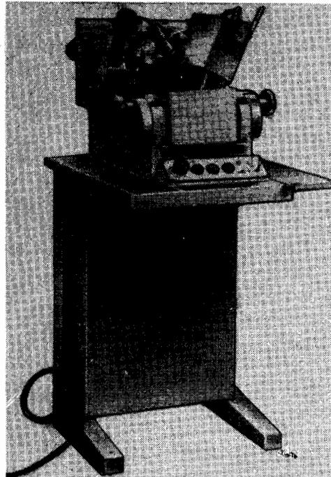
Предназначен для плоскостной заточки и переточки сверл диаметром 1-6 мм по ГОСТ 886-77, ГОСТ 4010-77, ГОСТ 10902-77, ГОСТ 17273-71, ГОСТ 17274-71 и ГОСТ 17275-71 из быстрорежущей стали и твердого сплава эльборовыми и алмазными шлифовальными кругами прямого профиля с охлаждением.
