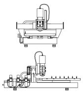
Основу конструкции составляет машины чугунная плита и стальная балку, расположенная над ней. Обрабатываемая деталь размещается на столе, который перемещается вдоль плиты и приводится в движение приводом "Х". Шпиндель с инструментом крепится в специальном кронштейне и перемещается вдоль балки приводом "Y", вертикальное перемещение осуществляется приводом "Z".
