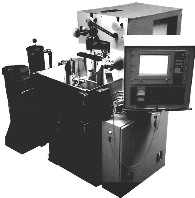
На станке предусмотрена возможность выполнения операции копирования формы электрода-инструмента на термоупрочненных деталях типа клейма различной сложности и формообразование на рабочей поверхности прессформ рельефа с знаковой информацией любой сложности (логотип предприятия и т.п.)
