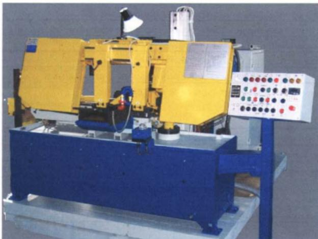
Станок предназначен для отрезки заготовок из проката и труб из черных и цветных металлов.
