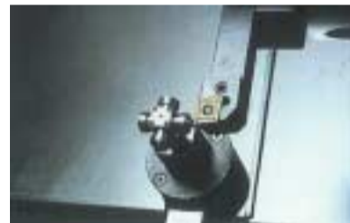
Устройство поднастройки инструмента на станке
