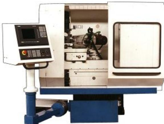
Применение устройства ЧПУ SINUMERIK 810D и вентильных двигателей производства фирмы "SIEMENS", Германия, гарантирует высокое качество управления центром, обеспечивает надёжную работу станка.
