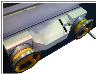
Рукоятка поперечного перемещения шлифовального круга
