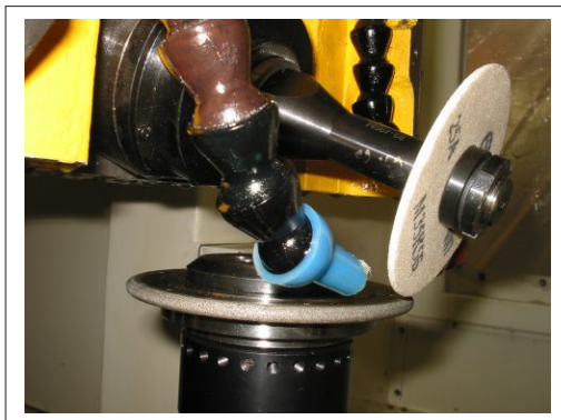
Правка шлифовального круга алмазным роликом
