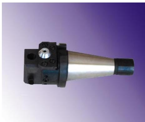
Крепится при помощи штревеля в вертикальном или горизонтальном шпинделе. В комплект поставки также входят необходимые ключи для закрепления резцов.
